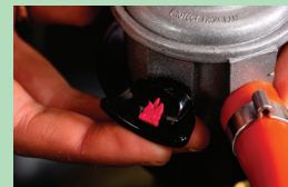
Før bruk må gassventilen åpnes, rød flamme opp
