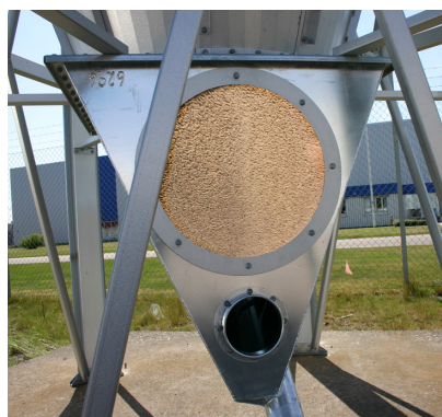
Manlucka i plexiglas. Tömningslucka/testlucka av fodret.
